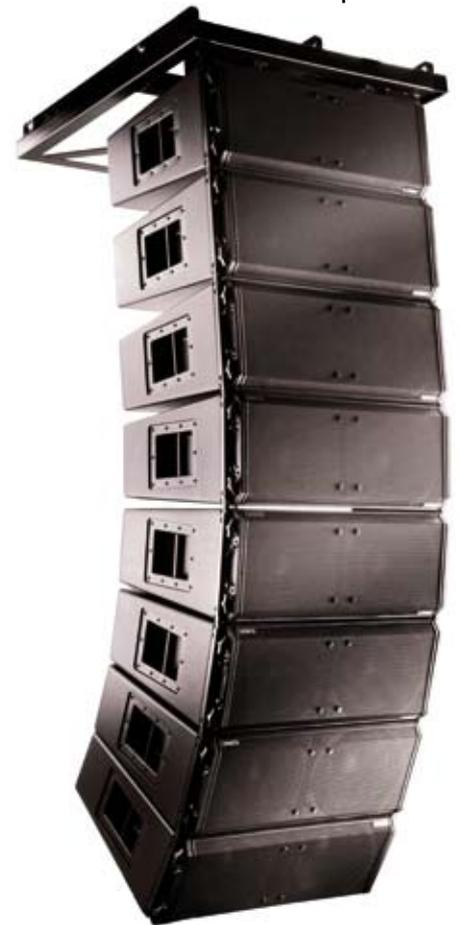
24 enceintes (facteur de charge 5:1). Une suspension de 12 enceintes conservera un facteur de charge de 10:1 qui peut être imposé par les réglementations et habitudes locales. Les angles verticaux d'écartement entre enceintes adjacentes sont réglables par degré, de zéro à dix degrés. Tout le matériel requis pour construire un ensemble est fixé de façon permanente à l'enceinte; aucune pièce éparsse ne peut être perdue.
