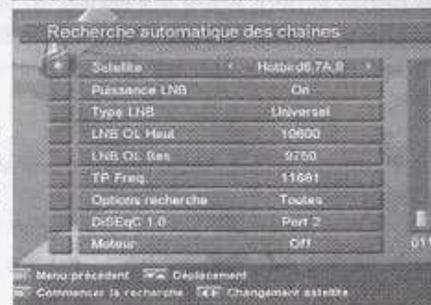
III - Tournez à la main et très lentement la parabole autour du tube dans la direction supposée du satellite (utilisez une boussole pour repérer à peu près sa direction). Dès que la barre devient jaune vous êtes sur le bon satellite, votre parabole est pratiquement réglée. Recherchez maintenant le maximum de "Qualité" en bougeant très légèrement la parabole (autour du tube et en hauteur (élévation)).
