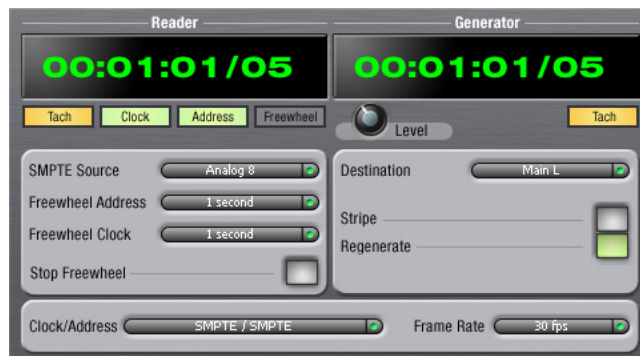
Figure 12-1: SMPTE Setup vous permet d'accéder à toutes les fonctions de synchronisation SMPTE de votre 8pre.
