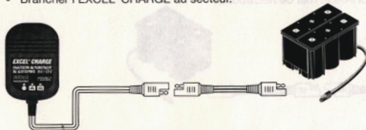
**REMARQUE :** dans tous les cas évoqués ci-dessus, si les polarités sont inversées, ni la diode jaune « charge », ni la diode verte « maintien », ne s'allument. Contrôler (et si nécessaire, corriger) les connexions.
