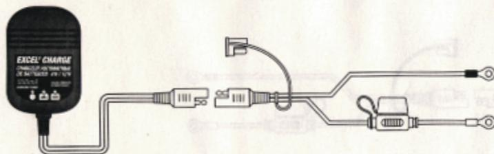
Dans le cas d'une **batterie Briggs & Stratton®** telle qu'illustrée ci-dessous, utiliser le cordon avec deux prises gigognes permettant l'inversion des polarités et réservé à la charge exclusive de ces batteries.
