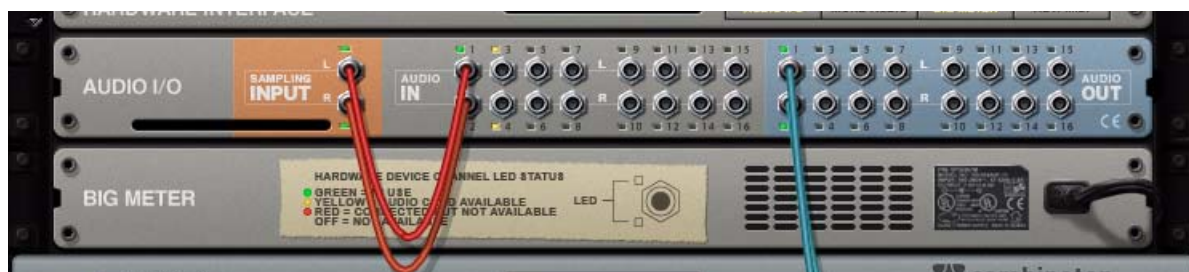
Entrées audio 1 et 2 connectées aux entrées de sample L et R pour un sampling en stéréo
