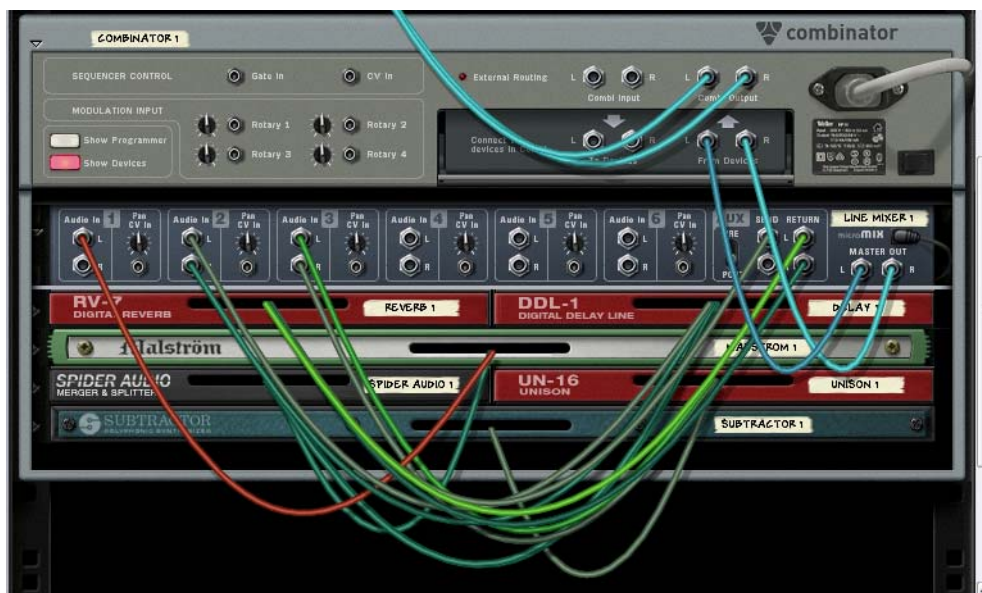
Des modules instrumentaux et d'effets connectés à un Line Mixer 6:2 à l'intérieur du Combi.
