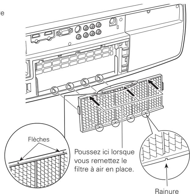
Lorsque vous remettez ce filtre à air en place, veillez à ce que les flèches marquées sur le filtre soient orientées vers le projecteur.
