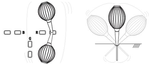
Lorsque vous effectuez le nettoyage, introduisez le bec dans le projecteur en le faisant onduler vers l'arrière et vers l'avant. (Ne tentez pas de faire plier le bec en forçant.)
