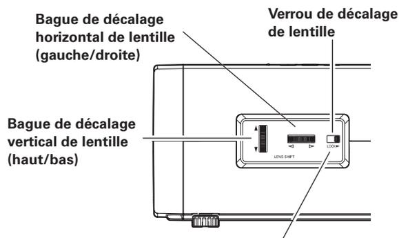
Avant d'utiliser les bagues de décalage de lentille, assurez-vous que ce verrou est bien déverrouillé.
