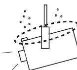
Lorsque vous suspendez le projecteur au plafond, nettoyez les orifices d'entrée d'air, les filtres à air, ou le haut du projecteur périodiquement à l'aide d'un aspirateur. Si vous n'effectuez aucun nettoyage du projecteur
