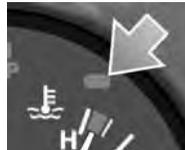
S'allume si la température du liquide de refroidissement devient excessive (aiguille du thermomètre dans la zone rouge). Il est dangereux de rouler si le circuit de refroidissement surchauffe.
