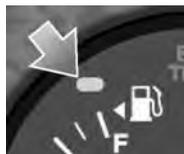
S'allume pour indiquer que le niveau de carburant est bas. Ce témoin s'ajoute à la jauge de carburant et s'allume lorsque le niveau de carburant est tombé à environ 10 litres (2,2 gallons).
