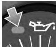
Ce témoin s'allume quand on met le contact et s'éteint quand le moteur est en marche. S'il reste allumé pendant la marche du moteur, cela indique une chute de
