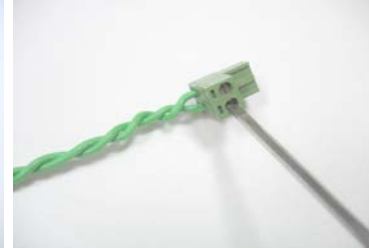
Figure 1.18 - Serrez la vis pour fixer le câble périphérique au connecteur
