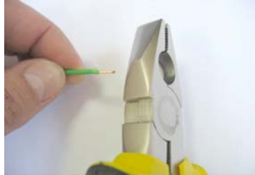
Figure 1.17 - Dénudez 6mm d'isolation à l'extrémité du fil
