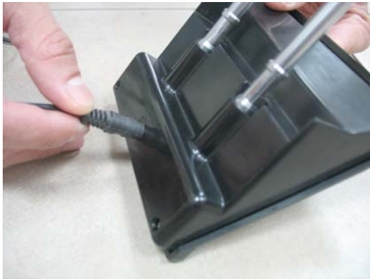
Figure 3.1 Connexion de l'alimentation électrique à l'adaptateur de rechargement
