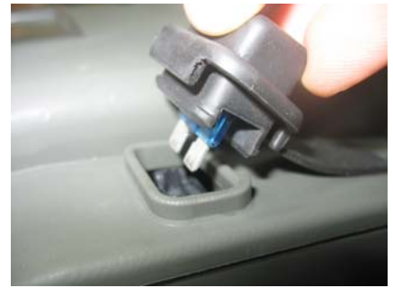
Figure 1.22 - Introduction du fusible des batteries
