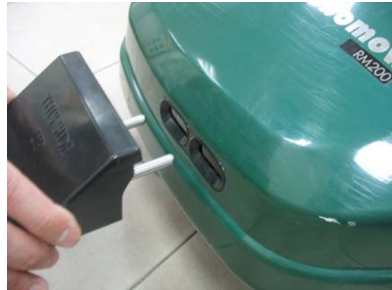
Figure 3.2 Connexion de l'adaptateur de rechargement à Robomow®
