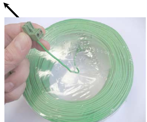
Figure 1.10 – Tirez le câble de son enveloppe en plastique – ne retirez pas le câble de l'enveloppe; elle sert de distributeur.
