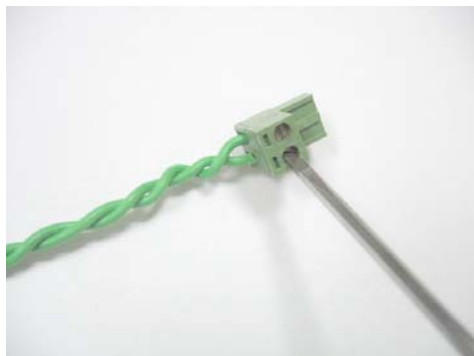
Figure 1.16 - Serrez la vis pour fixer le câble périphérique à la prise
