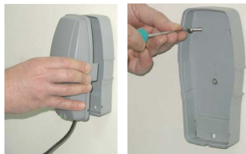
Figure 1.4 - Appuyez sur les languettes des deux côtés pour retirer le couvercle
