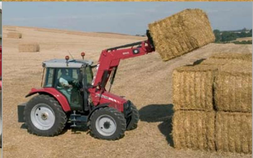
Les adaptations et potences de tous les modèles sont conçues pour faciliter l'accès au tracteur pour l'entretien. Le chargeur peut être verrouillé en position relevée en toute sécurité ; sinon, le système « Lock & Go » permet de retirer tout chargeur de la série MF 900 en un clin d'œil pour un meilleur accès au tracteur.
