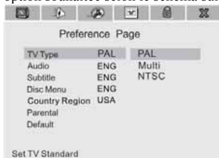
Cet appareil est compatible avec la sortie de divers systèmes, tels que AUTO, NTSC, PAL.
