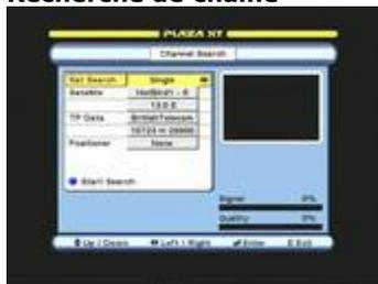
**Recherche Sat** : Sélectionner 'Single' (Unique) en cas de recherche manuelle. Sélectionner 'Multiple' en cas de recherche automatique.
