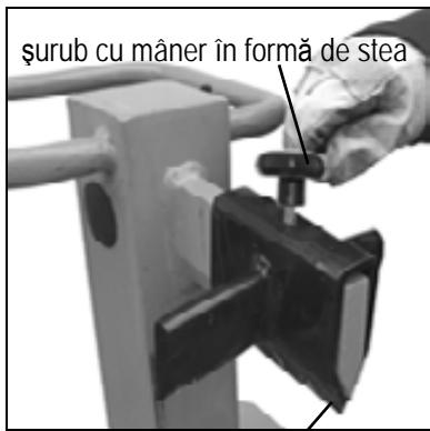
cruce de despicaț
