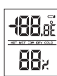
Display LCD con tutti i segmenti con icona di batterie scariche nell'angolo in alto a destra
