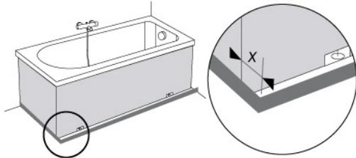
a. **plaquer** la plinthe comme indiqué ci-dessus et mesurer la cote (x) entre l'angle du panneau et la plinthe.
