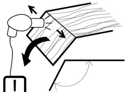
**nota :** il est conseillé de plier au delà de l'angle souhaité afin de permettre au décor de bien se plaquer au tablier.
