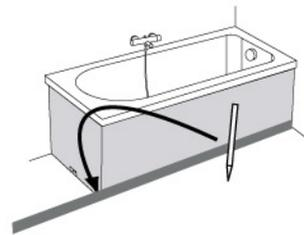
tracer à un trait à l'intérieur de la plinthe au niveau de l'angle formé par le panneau
