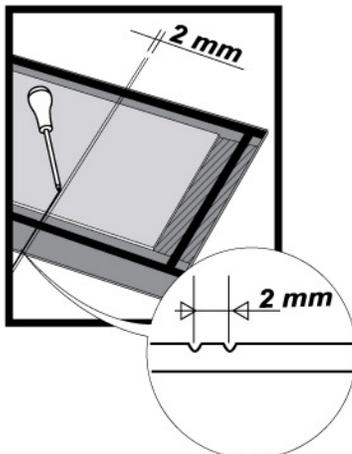
2. **chauffer**, en regard du double rainurage coté décor, pendant 3 minutes à l'aide d'un sèche cheveux en réalisant des allers/retours à une vitesse de 10 secondes par A/R.
