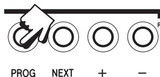
Um in den RUN-Modus zurückzukehren - drücken Sie **PROG**, bis der Doppelpunkt in der Anzeige blinkt.
