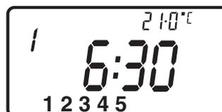
Tilbage til RUN-tilstand – tryk på **PROG**, indtil kolonnet blinker i displayet.
