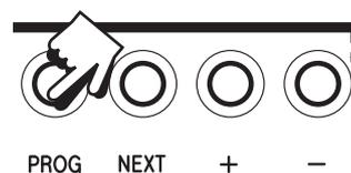
Volver al Modo FUNCIONAR (RUN) - oprimir **PROG** hasta que el signo de dos puntos centellea en la pantalla.
