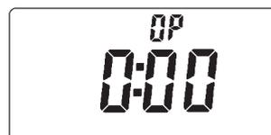
Verwenden Sie die Tasten **+** oder **-**, um die OSC-Periode zu wählen. Zur Auswahl stehen 0:30 (30 Minuten), 1:00 (1 Stunde), 1:30 und 2:00.
