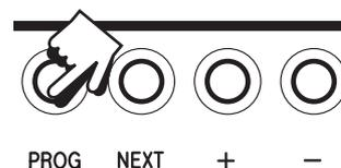
Vraćanje na Radni mod – pritisnuti tipku **PROG** dok dvotočka na zaslonu ne počne treperiti.
