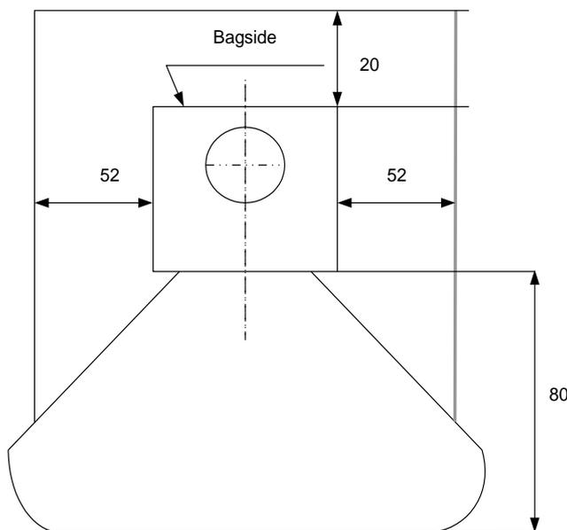
**Bemærk:** at brændeovnen skal installeres på et gulv med tilstrækkelig bæreevne. Hvis den eksisterende konstruktion ikke opfylder denne forudsætning, skal der foretages passende foranstaltninger (fx belastningsfordelende plade) for at opnå dette.
