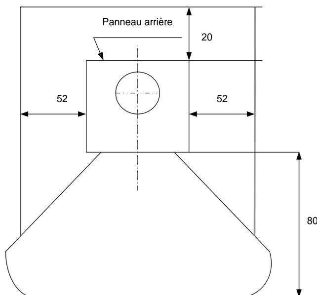
Remarque: le poêle à bois doit être installé sur un sol ayant une force portante adéquate. Si la construction existante ne remplit pas cette condition, il convient de prendre les mesures appropriées pour corriger la situation (p.ex. en installant une plaque de répartition de la charge).
