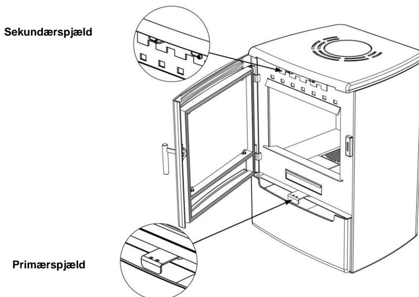
**Bemærk:** betjeningsgreb bliver varme, når brændeovnen bruges. Anvend derfor den medfølgende handske til betjening af brændeovnen.
