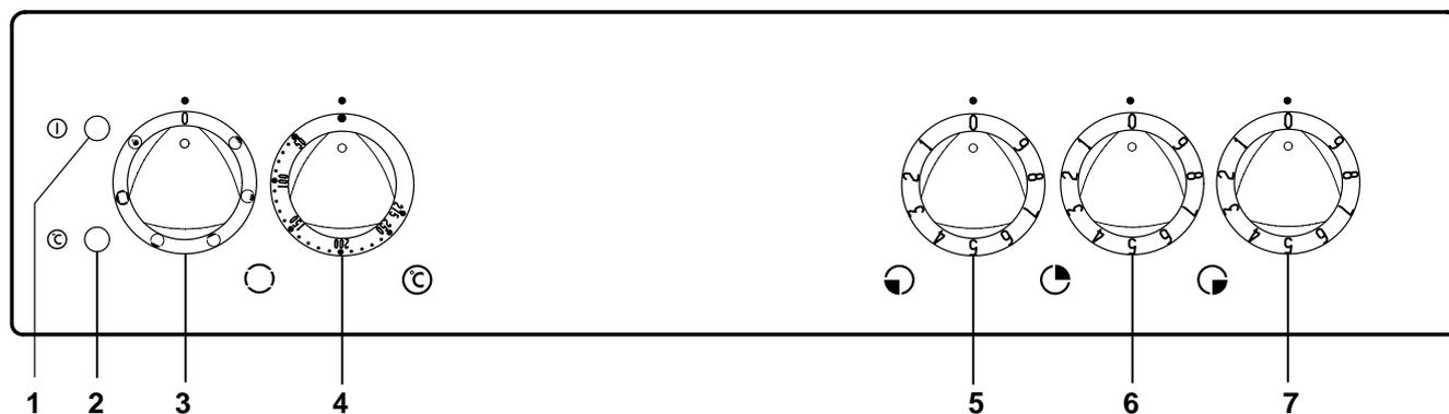
1. Lampe de contrôle fonctionnement du four
