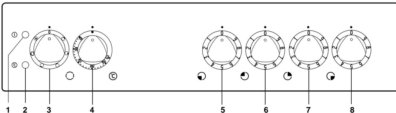
1. Lampe de contrôle fonctionnement du four et les plaques chauffantes
