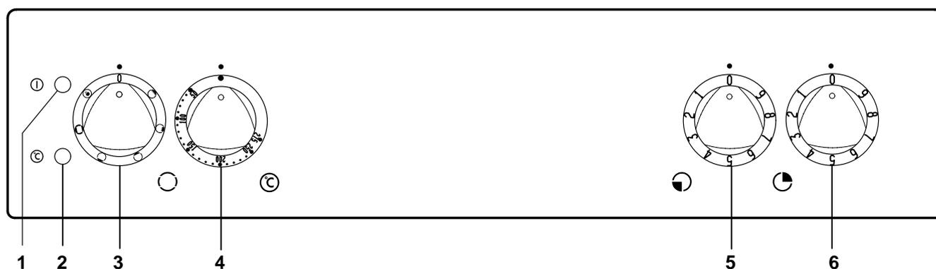
1. Lampe de contrôle fonctionnement du four
