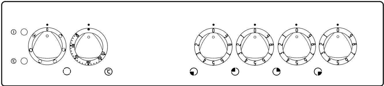
Les quatre commutateurs de droite situés sur le panneau de commande servent à enclencher et à régler la température des zones de chauffage vitrocéramiques ou des plaques de cuisson.
