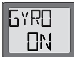
Un actionnement de la touche de saisie des données pendant 0,5 seconde vers l'avant permet de faire passer la mention clignotante de 'INH' sur 'ON'. L'option de mise au point de la sensibilité du gyroscope est ainsi établie.
