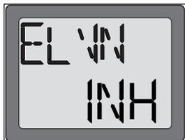
Le dispositif de mixage Delta ne peut pas être activé simultanément avec la fonction Flaperon ni avec le dispositif de mixage papillon. Si un de ces dispositifs de mixage était déjà en marche, la mention ci-contre apparaît sur l'écran. Il n'est possible d'effectuer une saisie que lorsque ces fonctions auront été désactivées.
