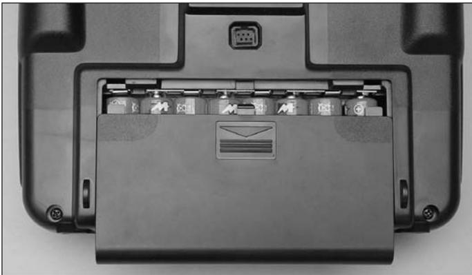
Nous vous recommandons aussi bien pour l'émetteur que pour l'alimentation du modèle lui-même d'utiliser des accus entièrement confectionnés étant donné qu'avec des éléments individuels les vibrations sont susceptibles de provoquer des interrupteurs dans l'alimentation électrique.
