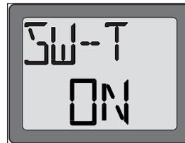
Un actionnement de la touche de saisie des données pendant 0,5 seconde vers l'avant permet de faire passer la mention clignotante de 'INH' sur 'ON'. Le dispositif de mixage est activé et peut être programmé.
