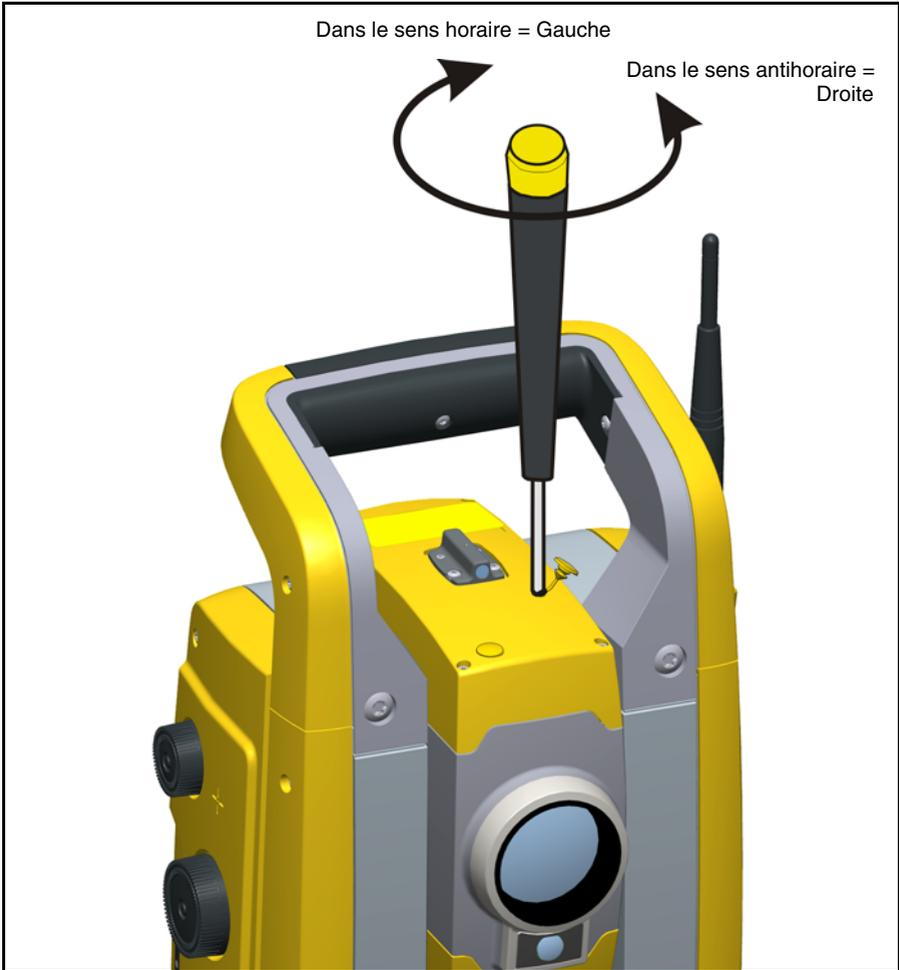
Figure 4.24 Réglage de position horizontale
