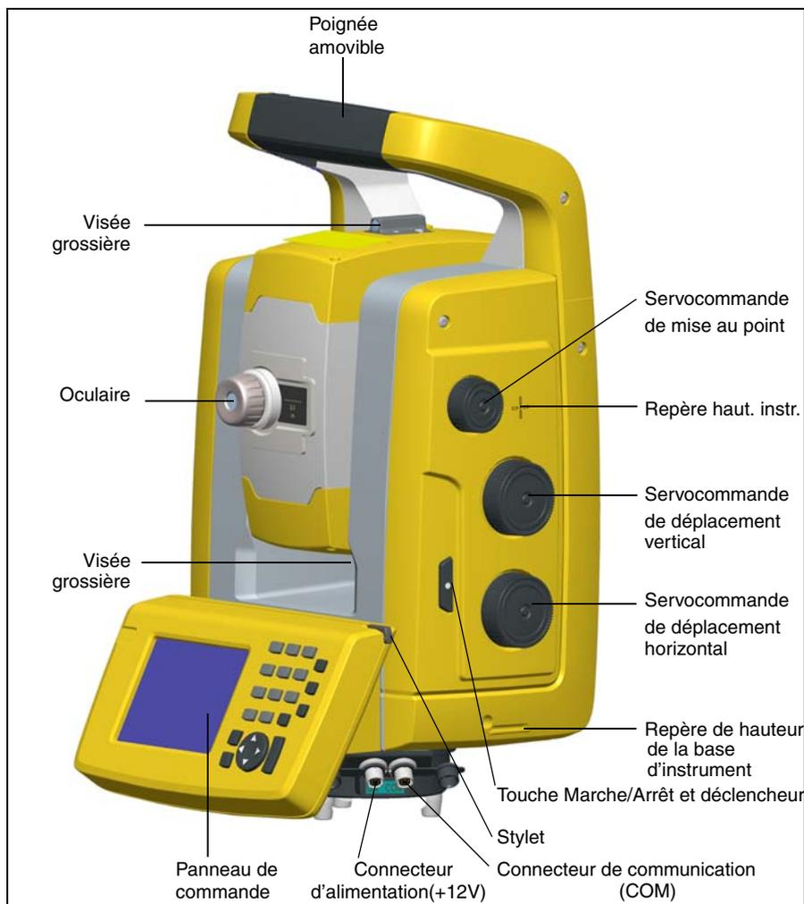
Figure 3.10 Vue côté opérateur de la Station totale Trimble S3 Servo/Autolock
