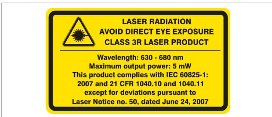
Figure 3.5 Étiquette d'avertissement de pointeur laser
