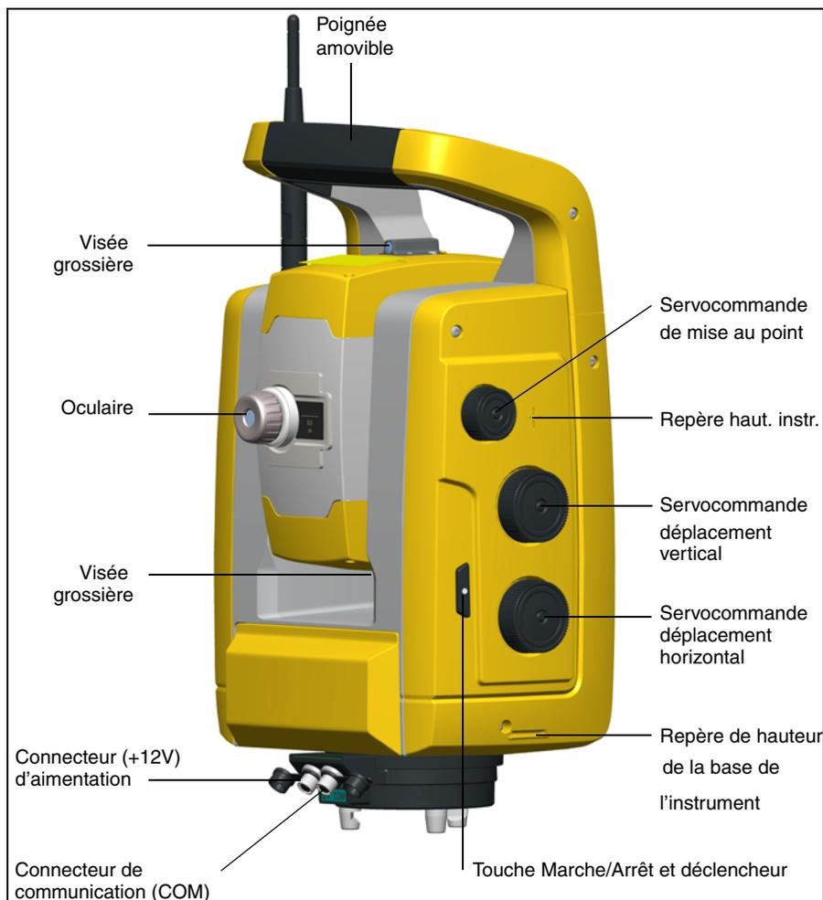
Figure 3.8 Vue côté opérateur de la Station totale Trimble S3 robotique
