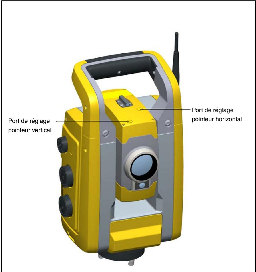
Figure 4.22 Ports de réglage du pointeur laser
