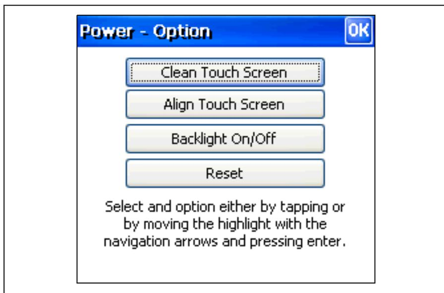
Figure 3.18 Fenêtre de l'option alimentation
