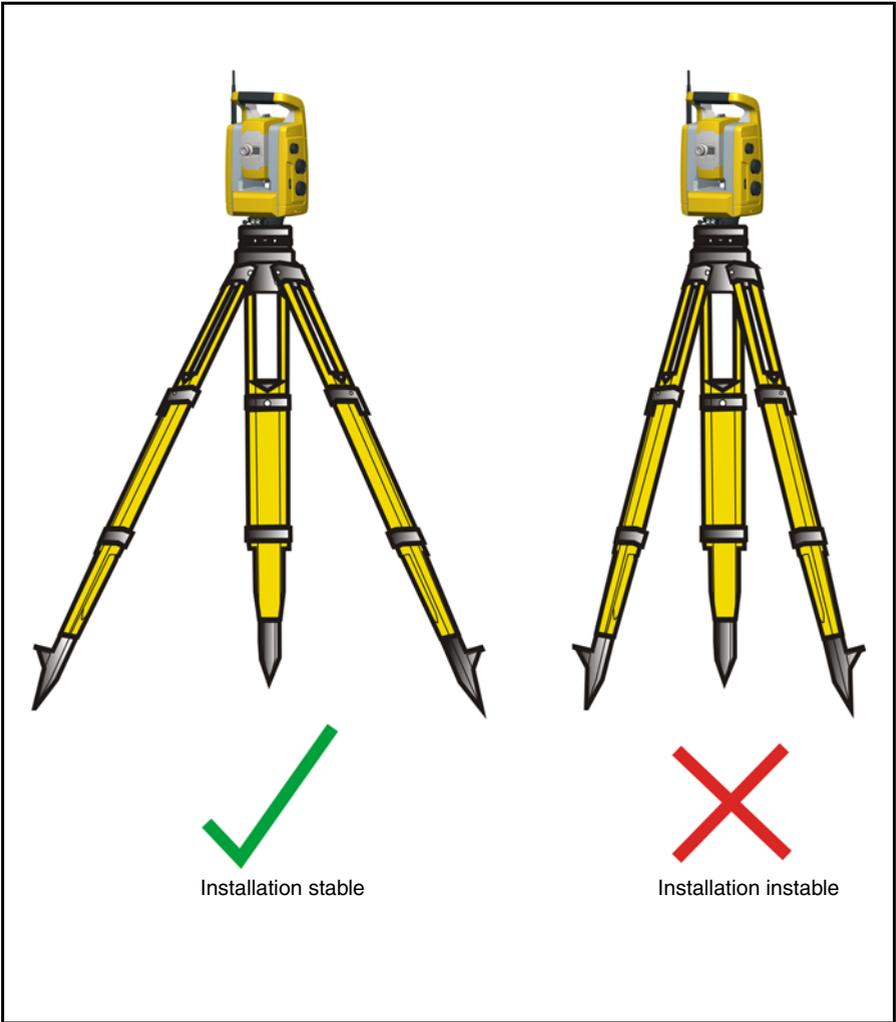
Figure 5.37 Installation du trépied
