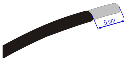
Figura 6: Retirada de la envoltura del cable CAT
