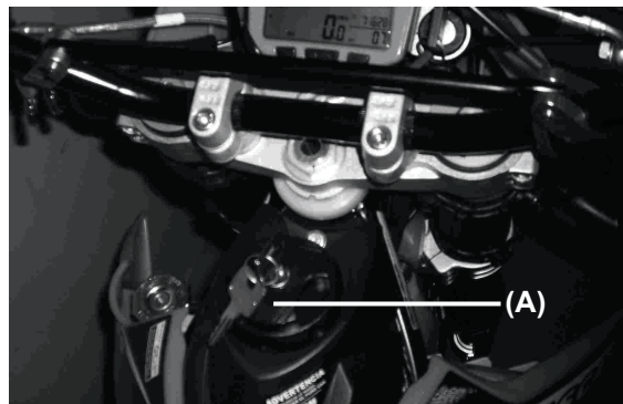
(A). Bouchon du réservoir. (B). Tuyau de ventilation des vapeurs.
