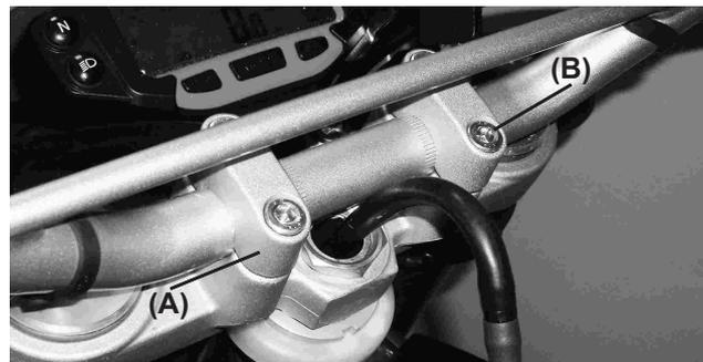
Procéder au serrage en commençant par les vis avant et en appliquant un couple de 25 Nm. Si le guidon est correctement installé, il doit rester un espace minimum devant et derrière après son serrage **A**.
