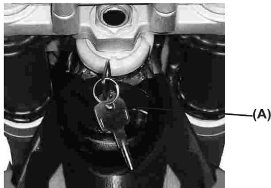
Le réservoir possède un bouchon avec clé **A**.
