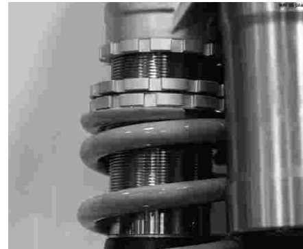
(A). Écrou (B). Ressort. (C). Contre-écrou.
