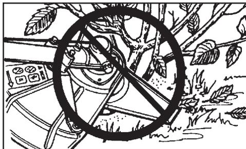
**La lame à herbe 8 dents** réf. 69600120331, est conçue pour le gazon, les débris et les mauvaises herbes épaisses. **NE PAS** utiliser cette lame pour tailler des broussailles ou des arbustes de 19 mm (3/4 po) de diamètre ou plus.
