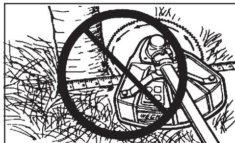
**La lame de défrichage à 22 dents** réf. 99944200130, est conçue pour la coupe de broussailles denses et arbrisseaux jusqu'à 64 mm (2 1/2 po) de diamètre.
