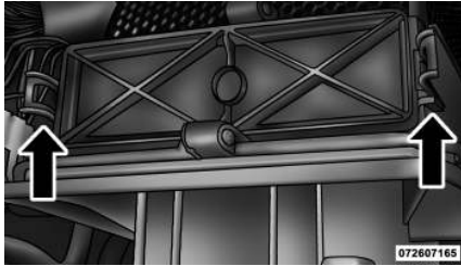
Remplacement du filtre à air de climatisation
