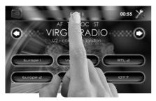
À l'aide de la touche de sélection de bande (ra), choisissez entre les bandes de stockage de station FM1, FM2, FM3 & MW.
