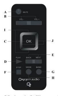
A Bouton de mise en/hors tension, de contrôle de sourdine et de volume.
