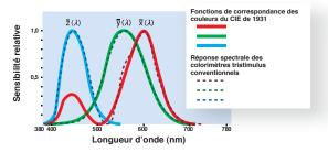
Fonctions de correspondance des couleurs du CIE de 1931 et réponse spectrale d'un colorimètre tristimulus conventionnel
