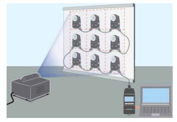
Système de mesure multipoints de l'éclairement lumineux (9 points)
