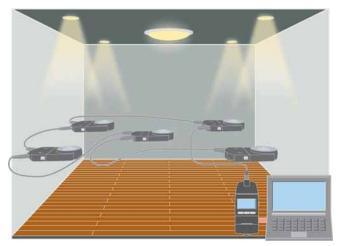
Système de mesure multipoints de l'éclairement lumineux (5 points)
