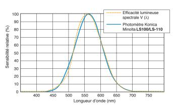
Dans l'idéal, le facteur de réponse spectrale du photomètre doit correspondre à V ( $\lambda$ ) de l'oeil humain pour une vision photopique. Comme l'illustre le graphique ci-dessus, le facteur de réponse des photomètres Konica Minolta **LS-100/LS-110** est inférieur à 8% (f1') de l'efficacité lumineuse spectrale CIE V ( $\lambda$ ).
