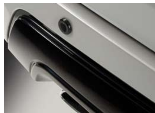
■ Les radars de recul vous aident lors des manoeuvres de stationnement grâce aux alertes sonores qui s'intensifient à l'approche d'un obstacle.
