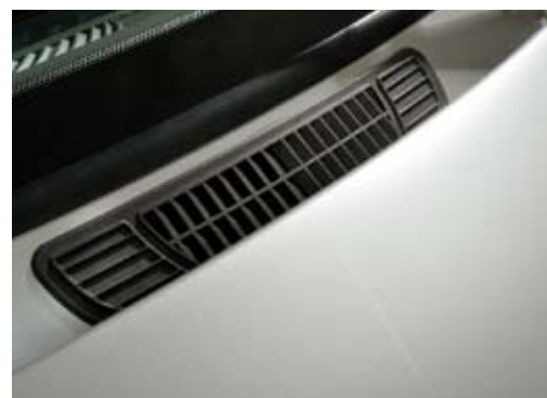
■ La prise d'air dynamique canalise l'air extérieur pour une ventilation et un chauffage de l'habitacle efficace.
