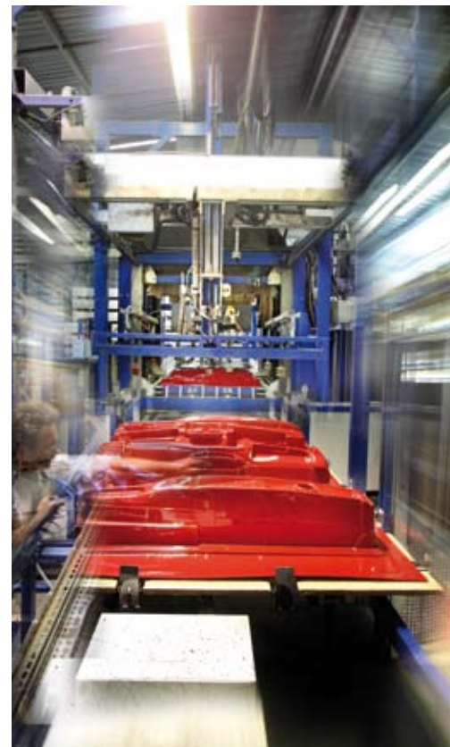
■ Les chaînes de thermoformage modèlent les pièces de carrosserie en ABS teintées dans la masse.
