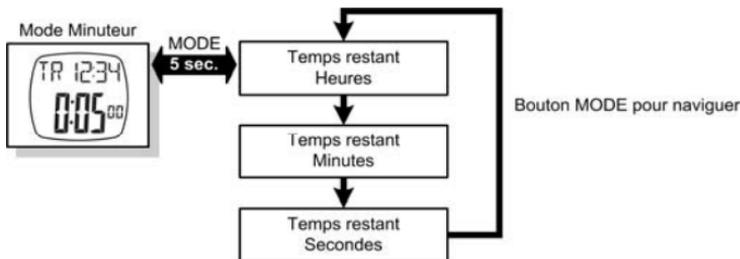
Appuyez sur le bouton MODE pendant environ 5 secondes. Les réglages que vous pouvez modifier clignotent. Modifiez ces réglages à l'aide des boutons START/STOP/RESET et SELECT. Pour naviguer entre les réglages des heures, des minutes et des secondes, appuyez sur le bouton MODE ; cette action permet en même temps de mémoriser les nouvelles valeurs.
