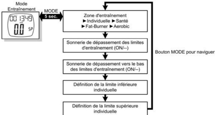
Appuyez sur le bouton MODE dans le menu principal Mode d'entraînement pendant environ 5 secondes. Vous arrivez dans le menu de réglage ; pour passer au réglage suivant, appuyez sur le bouton MODE. Les réglages que vous pouvez modifier clignotent. Modifiez ces réglages à l'aide des boutons START/STOP/RESET et SELECT. Validez avec la touche MODE.
