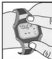
Laissez votre doigt sans interruption pendant 3 à 7 secondes sur la surface métallique du boîtier en exerçant une légère pression. Pendant la mesure, le symbole du coeur et les deux traits horizontaux au centre clignotent.
