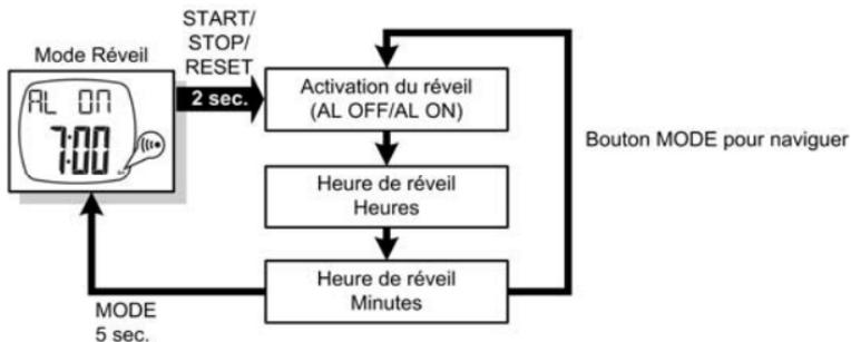
À partir de l'affichage de l'heure, appuyez sur le bouton START/STOP/RESET pendant au moins 2 secondes. Vous arrivez dans le menu de réglage ; pour passer au réglage suivant, appuyez sur le bouton MODE. Les réglages que vous pouvez modifier clignotent. Modifiez ces réglages à l'aide des boutons START/STOP/RESET et SELECT.
