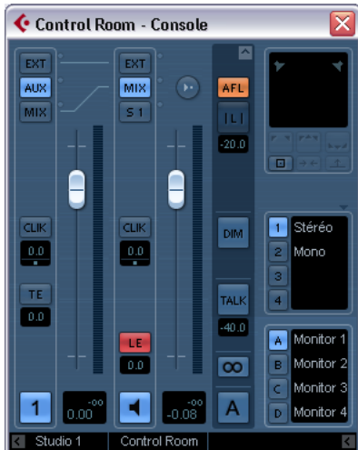
Une voie Studio dans la Console Control Room avec son entrée réglée sur Aux.
