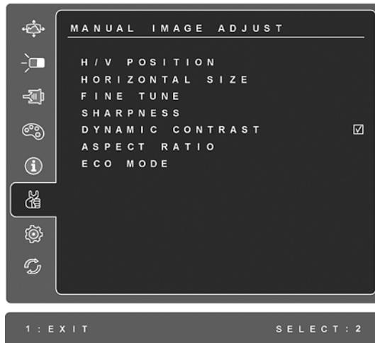
**H./V. Position (Position Horizontale/Verticale)** déplace la position de l'image à gauche ou à droite et en haut ou en bas.
