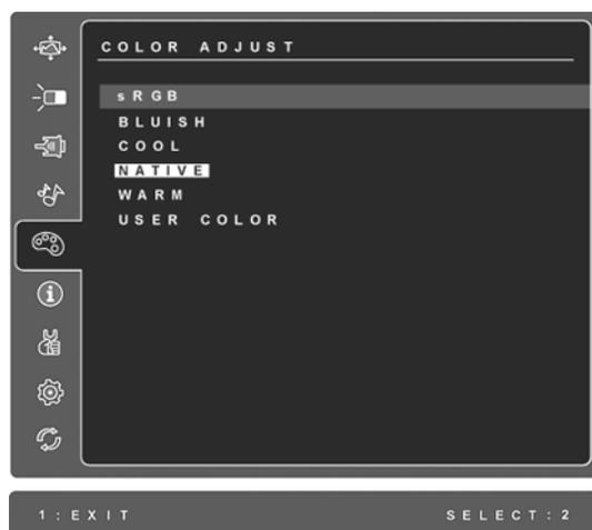
**sRGB**-est en train de devenir rapidement le standard de l'industrie pour la gestion des couleurs, et la plupart des applications récentes sont compatibles avec ce format. L'activation de ce paramètre permet à l'écran LCD d'afficher des couleurs plus fidèles à l'original. L'activation du paramètre sRGB entraîne la désactive les réglages du contraste et de la luminosité.
