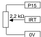
La plage d'action est de 1,5 à 10V. Une diminution de cette tension permet d'augmenter l'ensemble des temps ajustés par les potentiomètres ACC et DEC dans un rapport K variant de 1 à 6.
