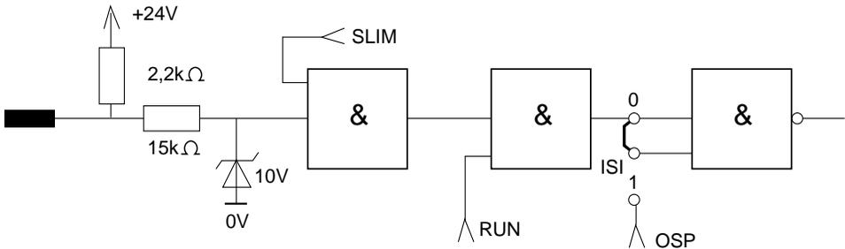
Pour annuler le terme intégral de la boucle vitesse, il suffit d'imposer 0V sur la borne ISI en effectuant la liaison borne ISI et borne 0V de la carte contrôle.
