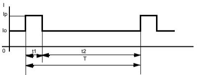
Il faut observer pour les Rectivar 4 série 44 les limites de temps suivantes :  $t_2 \geq 7 t_1$ ,  $t_1 \leq 8s$ .
