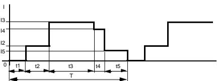
$$I_{\text{mte}} = \sqrt{\frac{I_2^2 t_2 + I_3^2 t_3 + I_4^2 t_4 + I_5^2 t_5}{T}}$$
