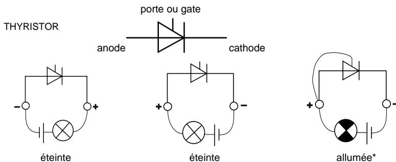
(\*) Nota : la lampe s'allume lorsque la porte et l'anode sont connectées, et reste allumée lorsque l'on débranche la porte.
