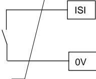
Il est également possible d'annuler le terme intégral pour  $N \leq 0,02$  fois  $N$  nominal en mettant le cavalier ISI sur la position 1, si le cavalier est sur la position 0 l'annulation de terme ne peut se faire que par la borne ISI sur le connecteur client.
