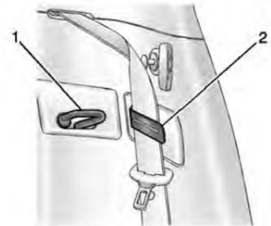
1. Mécanisme de verrouillage du dossier
