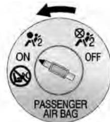
Pour réactiver les airbags de protection des genoux et frontaux pour passager avant, insérer la clé du véhicule dans le commutateur, l'enfoncer et la mettre en position ON.
