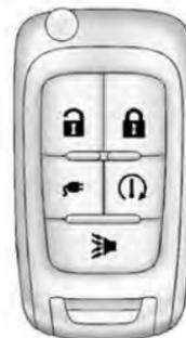
**🔒 (déverrouillage):** Presser une fois pour déverrouiller la porte du conducteur. Presser une deuxième fois dans un délai de cinq secondes pour déverrouiller l'ensemble des portes.
