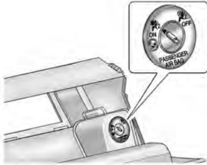
Les airbags de protection des genoux et frontaux pour passager avant doivent être désactivés si un système de sécurité pour enfant doit être posé sur le siège passager avant. L'airbag d'impact latéral monté sur siège passager avant, les airbags rideaux et tous les systèmes d'airbag conducteur restent actifs.
