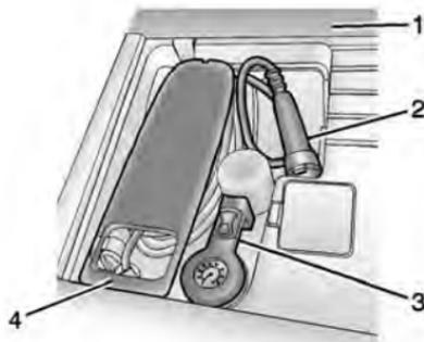
2. Ouvrir le hayon arrière, soulever le recouvrement de plancher de support de charge (1) et retirer le cordon de chargement (4). Il est situé près du kit de produit d'étanchéité et compresseur pour pneu (3). Tirer sur la poignée de cordon de chargement (4) pour le relâcher de son clip. Soulever et tirer vers l'arrière le cordon de chargement pour le retirer du véhicule. La prise du véhicule (2) est rangée comme cela est illustré.
