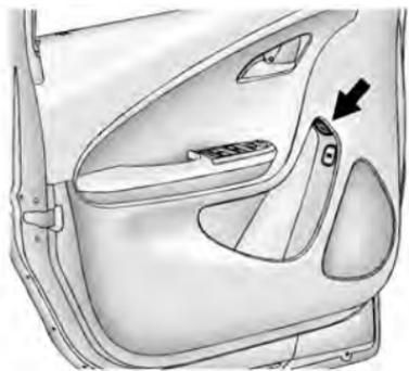
1. Appuyer pendant une seconde sur le bouton de trappe à carburant de la porte conducteur. Un message ATTENTE POUR RAVITAILLEMENT s'affiche sur le centre d'informations du conducteur.
