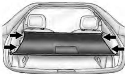
L'espace à bagages est équipé d'une plage arrière enroulable. Utiliser les quatre boucles de la plage arrière enroulable pour accrocher celle-ci aux panneaux latéraux.
