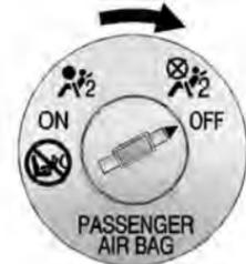
Pour désactiver les airbags de protection des genoux et frontaux pour passager avant, insérer la clé du véhicule dans le commutateur, l'enfoncer et la mettre en position OFF.
