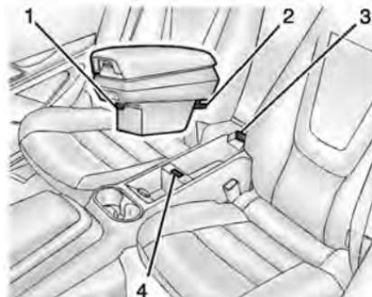
Pour reposer le casier de rangement d'accoudoir, aligner le support (2) sur l'arrière du casier de rangement d'accoudoir dans la fente (3) de la console arrière et pousser l'accoudoir jusqu'à ce que le loquet (1) se bloque dans l'ouverture (4).
