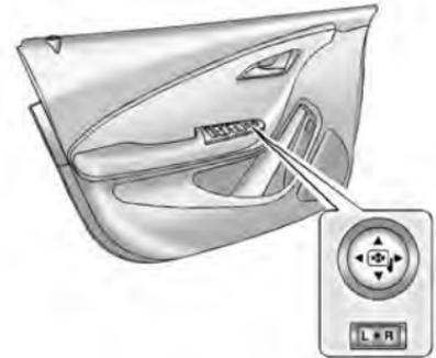
Les commandes pour les rétroviseurs électriques se situent sur la porte du conducteur.
