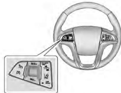
La commande de l'alerte de collision se trouve sur le volant. Appuyer sur ALERTE DE COLLISION pour régler la temporisation d'alerte sur
