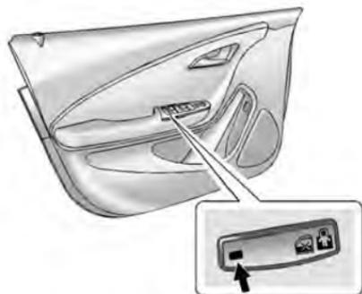
Le commutateur de verrouillage des vitres se trouve sur la porte conducteur. Ce dispositif empêche le fonctionnement des vitres passagers arrière, sauf pour le conducteur.
