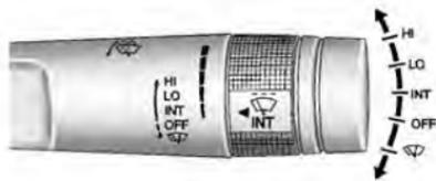
La manette d'essuie-glace/lave-glace avant se trouve sur le côté de la colonne de direction. Lorsque le contact est en position ACC/ACCESSORY (accessoires) ou ON/RUN/START (en fonction/
