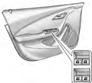
Les commutateurs de vitres situés sur la porte du conducteur commandent l'ensemble des vitres du véhicule. Chaque portière dispose d'un commutateur qui commande uniquement cette vitre.
