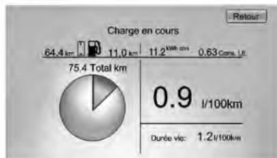
Les informations de consommation d'énergie s'affichent également automatiquement, le moteur coupé, lorsque la réserve d'alimentation est active. Cette fenêtre automatique peut être désactivée lors de la personnalisation du véhicule. Consulter « Fenêtre de fermeture de résumé d'énergie » sous *Personnalisation du véhicule* à la page 5-57.
