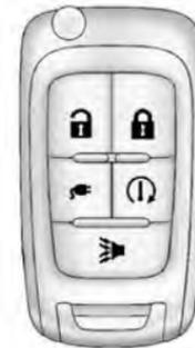
Le véhicule peut disposer d'une fonction de fonctionnement à distance des vitres permettant d'ouvrir toutes les vitres depuis l'extérieur du véhicule en maintenant enfoncé
