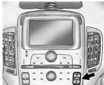
Les commutateurs de serrure de porte électrique sont situés sur la console centrale.
