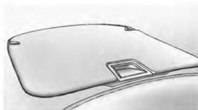
Un compartiment de rangement contenant une prise de courant auxiliaire se trouve sur le haut du tableau de bord.
