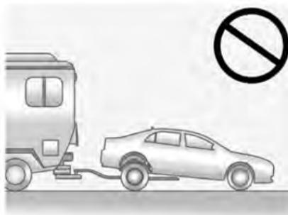
**Remarque:** Le remorquage du véhicule par l'arrière, roues avant sur le sol, peut endommager l'unité d'entraînement et le carénage avant. Ne pas remorquer le véhicule par l'arrière, roues avant sur le sol.
