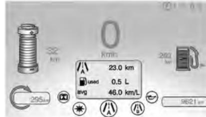
Le centre d'informations du conducteur s'affiche sur le combiné d'instruments. Le CIB affiche l'information au sujet du véhicule. Il peut aussi afficher des messages d'avertissement si un problème est détecté dans le système. Se reporter à *Messages du véhicule* à la page 5-46 pour obtenir plus d'informations.
