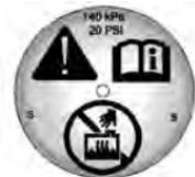
Le bouchon de pression du vase d'expansion de liquide de refroidissement peut être retiré lorsque le système de refroidissement, y compris le bouchon de pression du vase d'expansion de liquide de refroidissement et le flexible supérieur du radiateur, n'est plus chaud.
