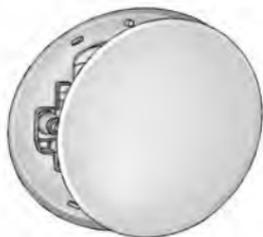
2. Lorsque le message PRÊT POUR RAVITAILLEMENT s'affiche, la trappe à carburant du côté passager se déverrouillera. Pousser et relâcher le bord arrière de la trappe à carburant pour ouvrir la trappe.
