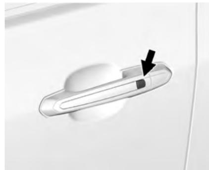
Lorsque l'émetteur du système d'accès à distance sans clé (RKE) se trouve à 1 m (3 pieds) de la porte du conducteur, la porte peut être verrouillée ou déverrouillée en appuyant sur le bouton de poignée de porte. Lors du déverrouillage de la porte conducteur, le premier
