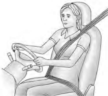
Les ceintures de sécurité sont bloquées lors des brusques accélérations ou décélérations du véhicule, ce qui permet de garder les occupants en position assise. Par conséquent, les risques de blessure sont considérablement moindres.
