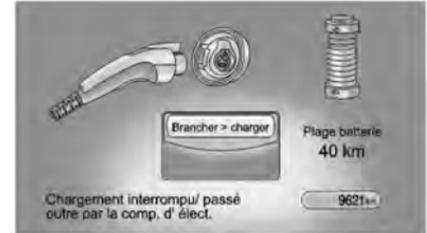
Cet écran signale que le cordon de chargement n'est pas raccordé. Raccorder le cordon pour recharger le véhicule.
