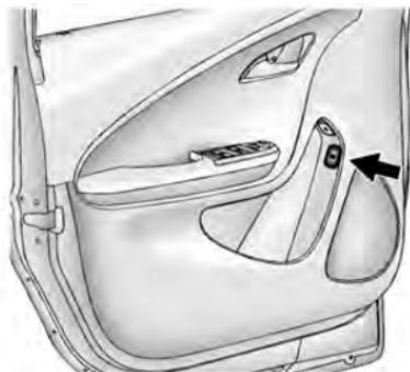
1. Le bouton de déverrouillage de la trappe du port de chargement se trouve sur le panneau de garniture intérieur de la porte conducteur. Avec le véhicule en position P (stationnement), appuyer sur le bouton pendant 1 seconde et relâcher pour ouvrir la trappe de port de chargement. La trappe du port de chargement peut également être ouverte à l'aide de l'émetteur RKE. Consulter *Fonctionne-*
