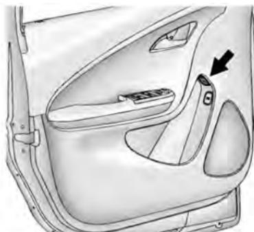
1. Appuyer pendant une seconde sur le bouton de la trappe de carburant situé sur la portière du conducteur. Un message WAIT
