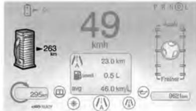
Cet indicateur affiche le niveau de carburant. Lorsque cet indicateur est au premier plan, cela signifie que le véhicule fonctionne en mode d'autonomie prolongée.
