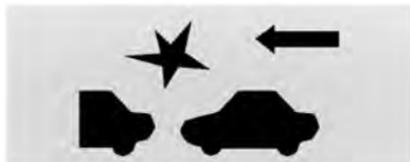
Lorsque votre véhicule approche un autre véhicule trop rapidement, l'écran du FCA rouge clignotera et une alarme sonore se fera entendre. Dans ce cas, le système de freinage se prépare pour que le freinage du conducteur se produise plus rapide-
