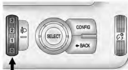
La commande de réglage manuel de la portée des phares se situe sur le côté extérieur de la colonne de direction. Cette fonction permet d'ajuster le niveau des phares selon la charge du véhicule. Un réglage correct du niveau des phares peut réduire l'éblouissement des autres usagers de la route.
