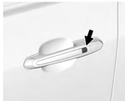
Lorsque l'émetteur du système d'accès à distance sans clé (RKE) se trouve à 1 m (3 pieds) de la porte du conducteur, la porte peut être verrouillée ou déverrouillée en appuyant sur le bouton de poignée de porte. Lors du déverrouillage de la porte du conducteur, le premier enfoncement déverrouillera uniquement cette porte ; appuyer de nouveau dans les cinq secondes qui suivent pour déverrouiller toutes les
