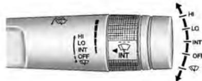
Lorsque le contact est en position ACC/ACCESSORY (accessoires) ou ON/RUN/START (en fonction/marche/démarrage), déplacer le levier pour sélectionner la vitesse de balayage.
