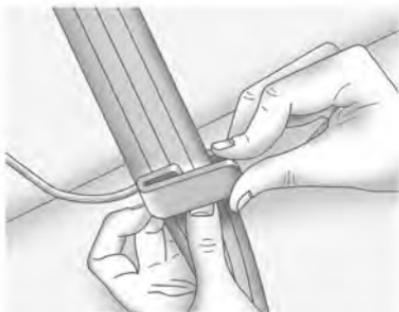
2. Placer le guide sur la ceinture et introduire les deux bords de la ceinture dans les encoches du guide.
