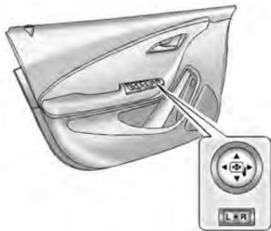
Les commandes électriques des rétroviseurs extérieurs se trouvent sur la porte du conducteur.
