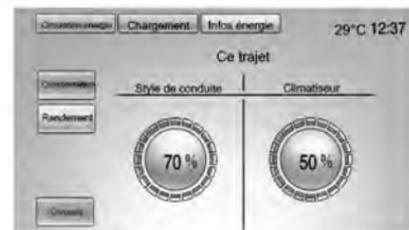
L'écran de rendement énergétique est accessible en appuyant sur le bouton Rendement énergétique sur l'écran Cons éner. Cet écran affiche l'efficacité énergétique au cours du cycle de conduite basé sur le style de conduite et les réglages de climatisation. Conduite de manière plus efficace se traduira par un pourcentage de style de conduite plus élevé à l'écran. Minimiser l'utilisation du système de climatisation se traduira par un pourcentage de réglage de climatisation plus élevé à l'écran.
