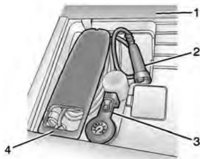
2. Ouvrir le capot arrière, soulever le revêtement de plancher du support de charge (1) et déposer
