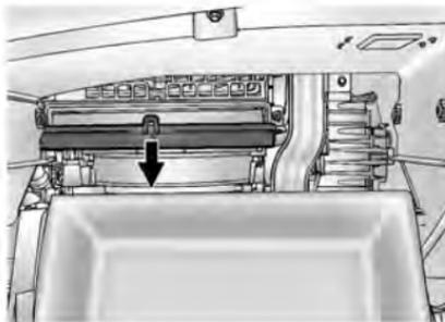
4. Déposer le filtre à air usagé.
