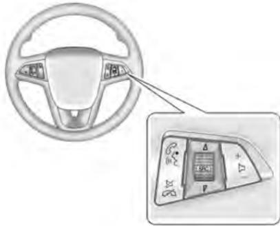
Sur les véhicules avec commandes audio au volant, certaines commandes audio peuvent être réglées au volant.
