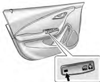
Les serrures de sécurité de porte arrière empêchent les passagers d'ouvrir les portes arrière depuis l'intérieur du véhicule.
