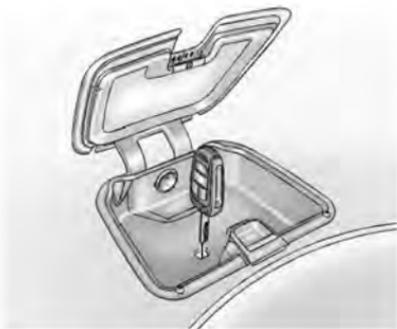
3. Déposer le tapis de caoutchouc situé dans le rangement du tableau de bord. Déployer la clé devant le nouvel émetteur et insérer la clé dans la rainure de l'émetteur.
