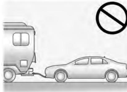
**Remarque:** Si le véhicule est remorqué avec les quatre roues sur le sol, l'unité d'entraînement peut être endommagée. Les réparations ne seraient pas couvertes par la garantie du véhicule. Ne pas remorquer le véhicule avec ses quatre roues sur le sol.
