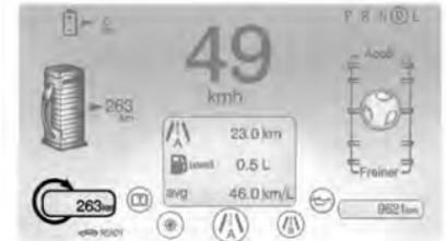
L'autonomie totale du véhicule est la distance restante que le véhicule peut parcourir en combinant autonomie électrique et autonomie de carburant.
