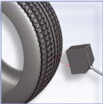
Inspection de profil
