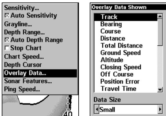
Commande de Superposition des Données dans le menu du Sondeur, à gauche. Menu de sélection des données de superposition affichées, à droite. Dans cet exemple, nous sommes descendus dans la liste pour sélectionner "Ground Speed."
