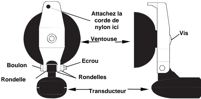
**Assemblage du transducteur portable : vue arrière (à gauche) et vue de côté (à droite).**
