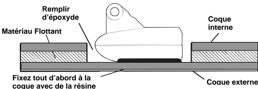
**Fixez le transducteur à la coque au niveau d'une portion compacte avec de la résine époxyde.**
