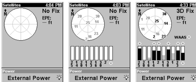
**Ecran Satellite.** La figure de gauche indique que l'appareil ne s'est aligné à aucun satellite et n'a pas encore établi sa position. La figure du milieu montre l'examen des satellites. La figure de droite indique un verrouillage satellite et l'acquisition d'une position 3D (latitude, longitude et altitude.)
