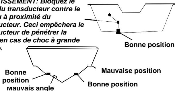
**Les bonnes et les mauvaises positions pour l'installation du transducteur.**
