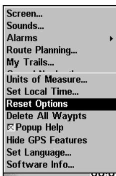
Menu du Système avec la commande de Réinitialisation des Options sélectionnée.
