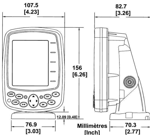
**Vues de face (à gauche) et de côté (à droite) illustrant les dimensions du Cuda 240 monté sur un support à dégagement rapide.**
