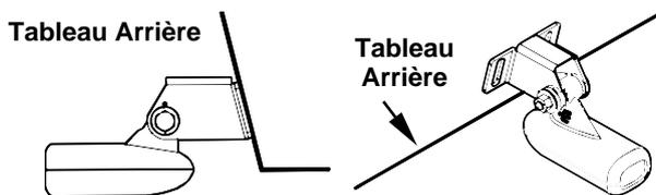
**Positionnez le transducteur sur le tableau et marquez l'emplacement des trous. Vue de côté à gauche et vue du dessus à droite.**
