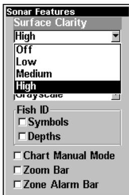
**Menu de Fonctions du Sondeur avec la Clarté de Surface sélectionnée.**
