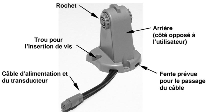
**Support de montage à démontage rapide du Cuda 240. Les fentes à la base du support permettent le passage du câble depuis le dessous du tableau de bord.**
