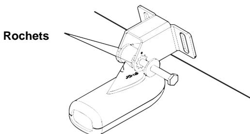
**Insérez le boulon et vérifiez la position du transducteur sur le tableau.**
