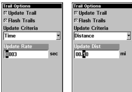
Menu d'Options des Tracés: réglages du Temps de Mise à Jour, à gauche, et de la Distance de Mise à Jour, à droite.
