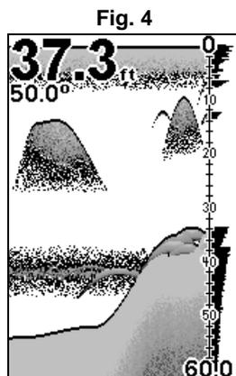
Ces figures montrent l'affichage d'une même zone avec des sensibilités différentes. Fig.1 : Sensibilité à 87%, Sensibilité Automatique typique du mode automatique. Fig.2 : Sensibilité réglée à 50%. Fig. 3 : Sensibilité réglée à 20%. Fig.4 : Sensibilité réglée à 100%.
