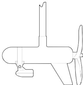
**Transducteur installé sur un moteur à la traîne, vue de côté.**
