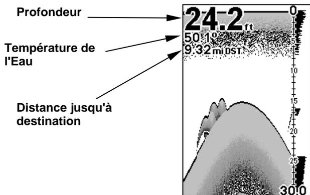
Affichage du Sondeur avec les Données de Superposition activées. Cet exemple montre la Profondeur, la Température de l'Eau et la Distance jusqu'au prochain waypoint de l'itinéraire actuel.
