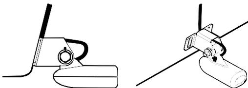
**Faites passer le câble par dessus le boulon et à travers le support. Vue de côté à gauche et vue du dessus à droite.**
