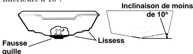
**A gauche, coque en V à fond plat; à droite, coque en V. Un transducteur-nacelle est illustré ici, mais le principe est le même pour les transducteurs Skimmers dans la coque.**
