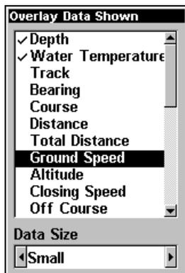
Liste de données montrant le type "Ground Speed" sélectionné pour être affiché sur l'Écran du Sondeur.
