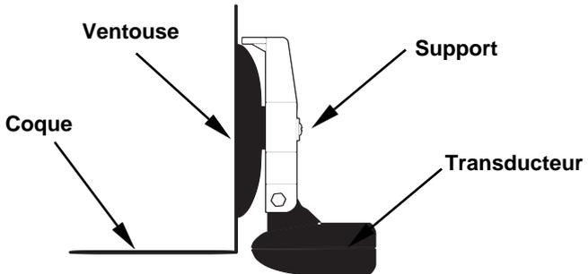
**Transducteur portable installé sur le tableau arrière du bateau.**
