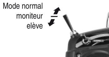
Pour changer de mode, mettez l'interrupteur de mode dans la position souhaitée, appuyez sur la touche BIND et maintenez-la enfoncée pendant que vous allumez l'émetteur.
