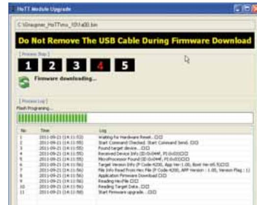
N'interrompez pas la procédure de mise à jour avant que la barre de progression n'ait atteint le bord droit et pas avant que le message „Firmware Download Success“ n'apparaisse- par ailleurs l'émetteur émet une brève mélodie de confirmation, et la LED passe de l'orange au vert:
