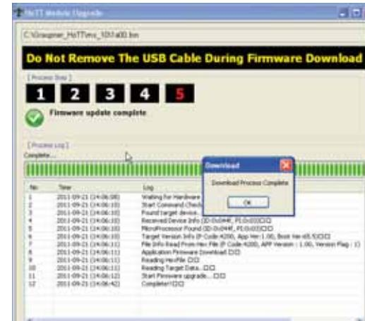
Klicken Sie auf „OK“. Schalten Sie anschließend den Sender aus und trennen Sie schließlich die Verbindung zum PC oder Laptop.
