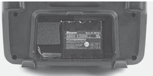
Den Akku entnehmen und dann Stecker des Senderakkus durch vorsichtiges Ziehen am Zuleitungskabel lösen.
