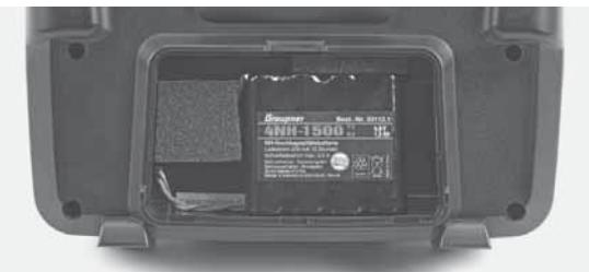
Enlevez l'accu puis débranchez avec précaution la prise de l'accu d'émission en tirant soigneusement sur le cordon.
