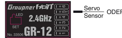
... kann alternativ nicht nur das Adapterkabel Best.-Nr. 7168.6A zum Updaten des Empfängers sondern auch ein Telemetrie-Sensor angeschlossen werden.
