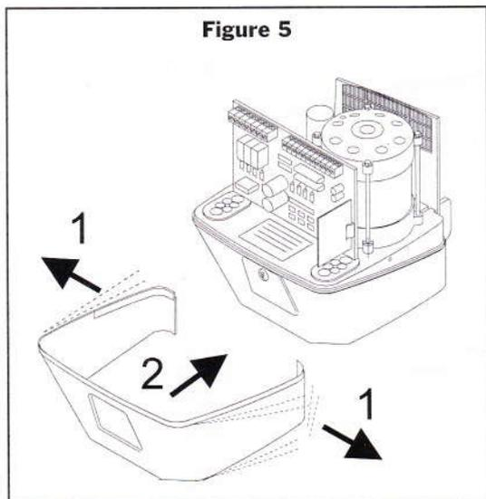
Mettre le capot supérieur suivant la figure 6 en le glissant dans le guide de l'opérateur.
