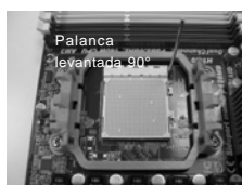
PASO 1: Levante la Palanca del Zócalo
