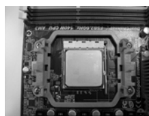
步骤 4： 下推并锁住插座拉杆
