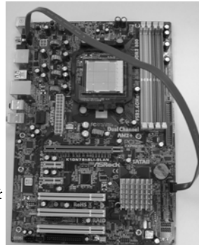
SATAデータケーブルをeSATAIIコネクタ(eSATAII_TOP)に接続します
