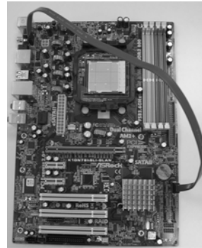
SATA 데이터 케이블을 빨간색 eSATAII 커넥터 (eSATAII_TOP)에 연결합니다.
