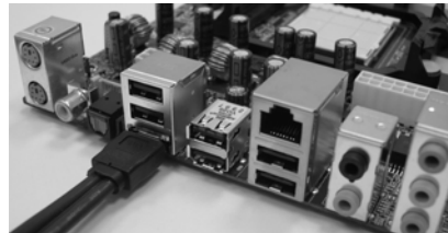
eSATAII 장치 케이블의 또 다른 끝을 I/O 쉴드의 eSATAII 포트에 연결합니다.
