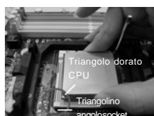
FASE 2 / FASE 3: Far corrispondere il triangolo dorato della CPU al triangolino nell'angolo del socket
