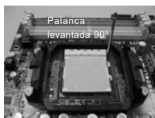
PASO 1: Levante la Palanca del Zócalo
