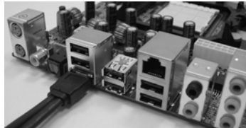
eSATAII デバイスケーブルのもう一方の端をI/OシールドのeSATAIIポートに接続します
