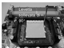
FASE 1: Sollevare la levetta socket
