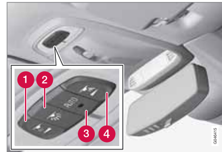
Commandes au plafond pour les liseuses avant et le plafonnier.
