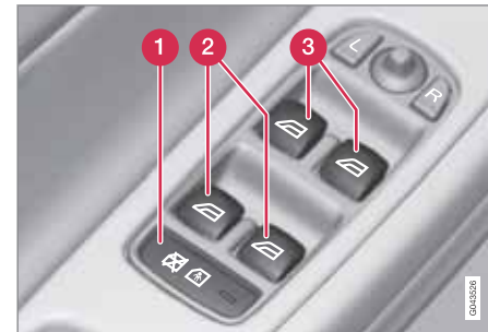
Panneau de commande de la porte conducteur.
