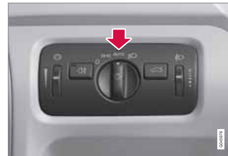
Commutateur d'éclairage en position AUTO .
