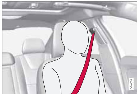
Ceinture de sécurité correctement placée.
