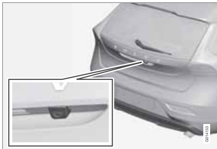
Emplacement de la caméra près de la poignée d'ouverture.
