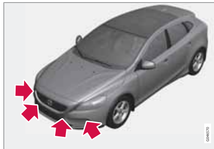
Emplacement des capteurs avant.
