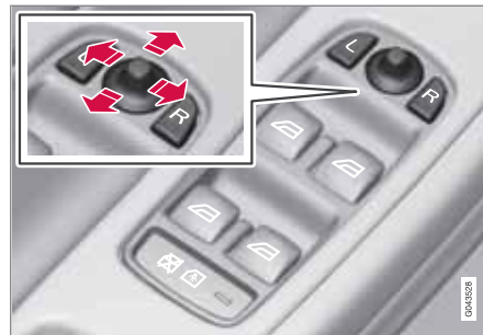
Commande des rétroviseurs extérieurs.
