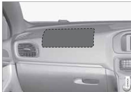
Emplacement du coussin gonflable du côté passager dans les voitures à conduite à droite.
