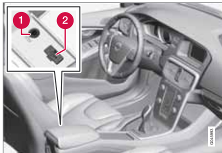
Points de connexion de sources sonores externes.
