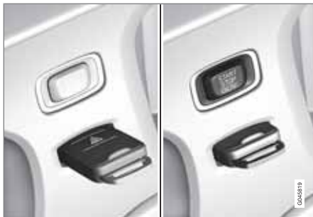
Contacteur d'allumage avec télécommande retirée/insérée.
