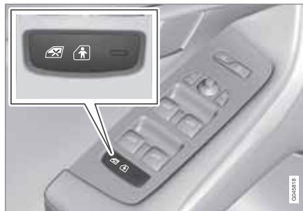
Panneau de commande porte conducteur.
