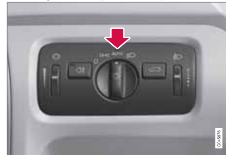
Commutateur d'éclairage en position AUTO .
