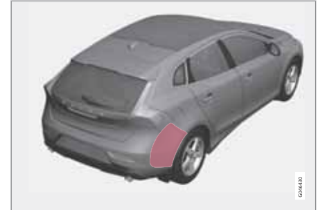
Placement du capteur BLIS et CTA.
