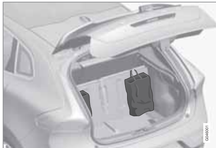
Dispositif de retenue pour sacs à provisions rabattable
