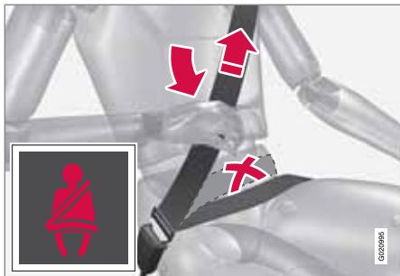
Ceinture de sécurité correctement placée.
