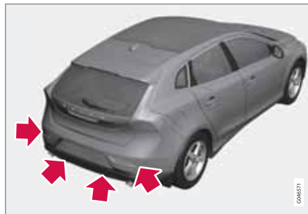
Emplacement des capteurs arrière.
