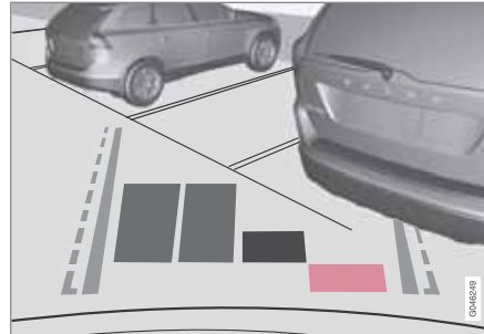
Les 4 champs colorés (un par capteur) indiquent les distances.
