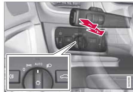
Commutateur d'éclairage et levier au volant.
