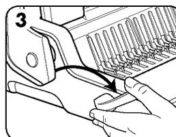
3. Tirer le levier d'ouverture des anneaux en plastique vers l'avant pour les ouvrir.
