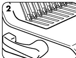
2. Insérer les anneaux en plastique dans le mécanisme.
