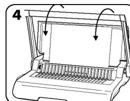
4. Procéder à un test de perforation de feuilles de brouillon pour vérifier le réglage de la butée de taquage.
