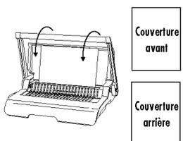
1. Perforer d'abord les couvertures avant et arrière.
