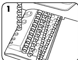
1. Sélectionner le diamètre de reliure correct dans le bac de stockage des anneaux en plastique.
