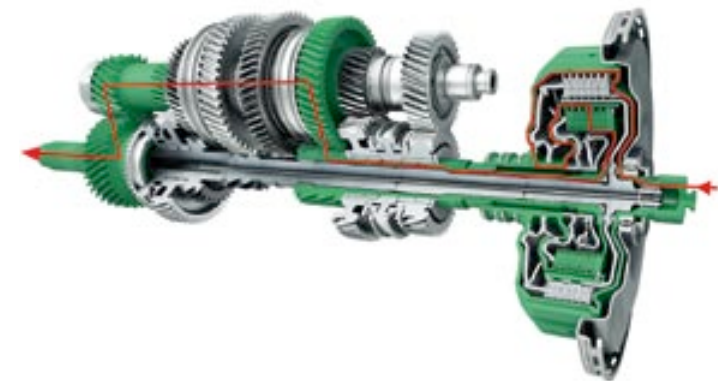
Flux de puissance en 2 e
