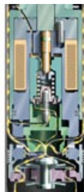
Régulation continue en fonction de la charge et de la vitesse
