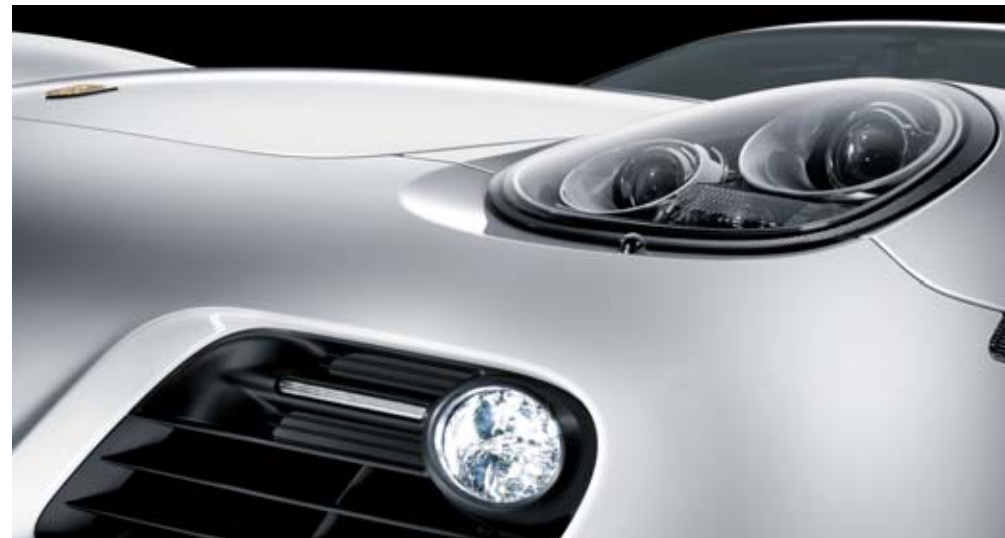
Phares Bi-Xénon avec contrôle de faisceau dynamique en virage et feux de jour à DEL
