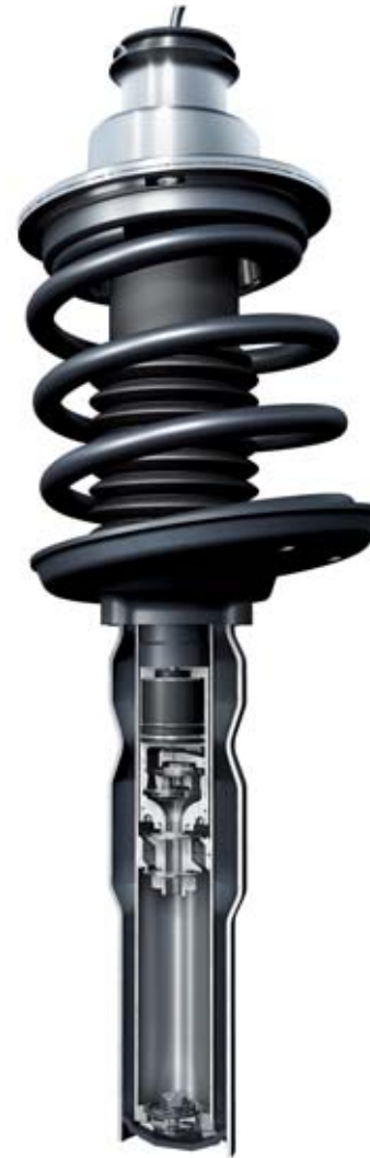
Phase de compression – Piston plus by-pass = réglage sportif confortable
