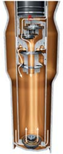
Phase de détente – Piston seul = réglage sportif confortable
