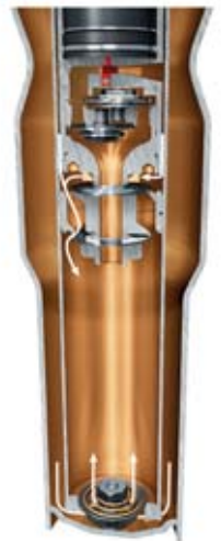
Phase de détente – Piston seul = réglage sportif plus ferme
