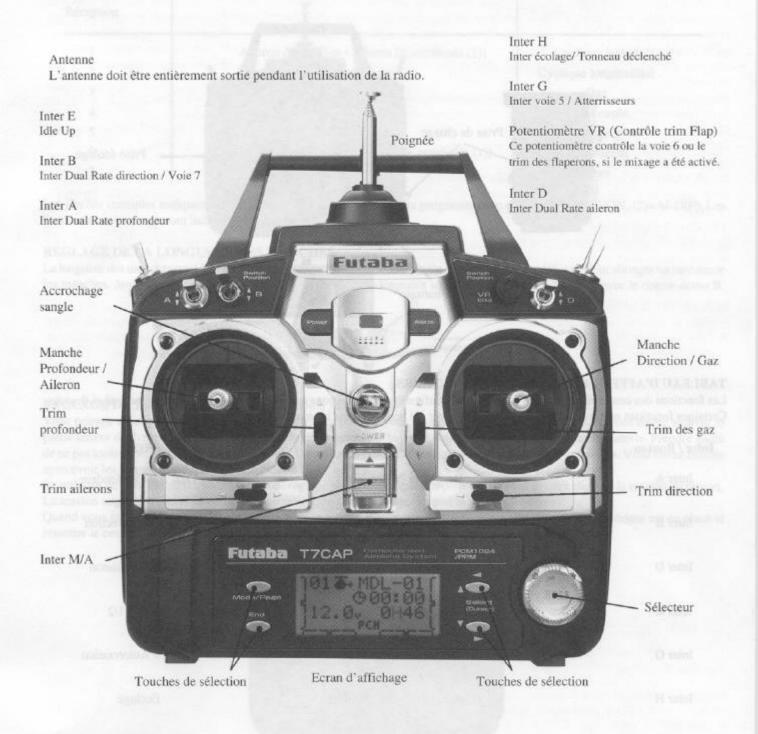
Cette figure montre les emplacements des commandes pour une radio configurée en mode 1. Vous pouvez modifier les fonctions ou la position des commutateurs en sélectionnant une nouvelle position dans le menu de réglage de la fonction que vous désirez déplacer.
