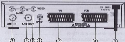
**3 ENTRÉE «ANT IN»** Entrée «Antenne» de l'adaptateur recevant le câble coaxial en provenance de l'antenne TNT ou de la prise TV. Le câble véhicule le signal TNT, mais peut aussi envoyer une tension de 5 Vcc (50 mA maxi en continu, 60 mA intermittents) servant à l'alimentation d'amplificateurs (intégré dans l'antenne ou de mât).
