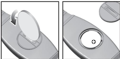
1. A l'aide d'une pièce de monnaie, tournez le couvercle dans le sens inverse des aiguilles d'une montre jusqu'à ce qu'il se détache.
