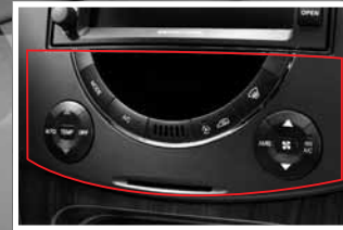
Panneau de commande de chauffage/climatisation
