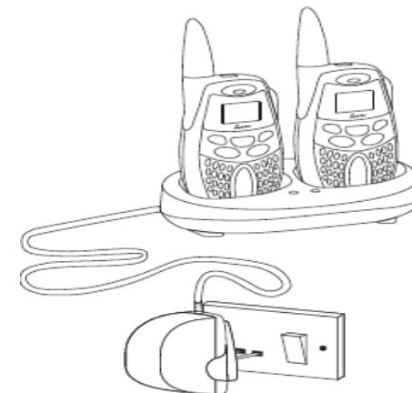
**4** Après avoir connecté le socle chargeur, mettez en charge pendant 10 heures les deux appareils.
